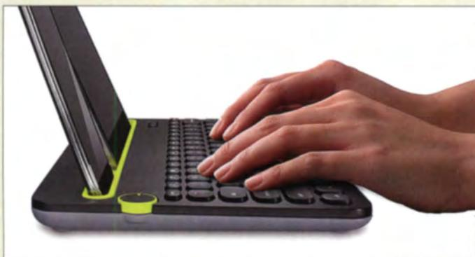
Die Umschaltung zwischen den Geräten erfolgt bei der **K480** über das seitliche Drehrad.
