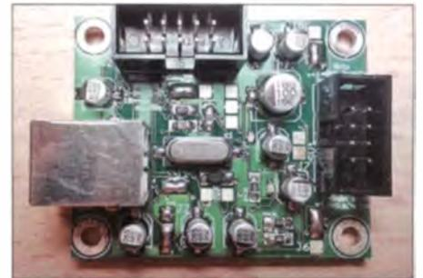
**Bild 7:** Eigenbauplatine mit USB-B-Buchse, 10-poligem Wannenstecker für acht I/Os, +5 V, GND und 8-poligem Wannenstecker für NF-TX, NF-RX, NF-Lautsprecher, PTT, Squelch, Subaudiotriterium, +5 V, GND
