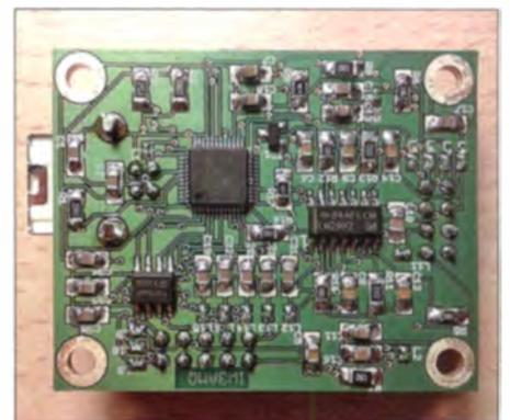
**Bild 8:** Unterseite der Eigenbauplatine aus Bild 7; erkennbar sind der Soundchip CM108 bzw. CM119, Operationsverstärker und EEPROM.
