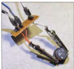
**Bild 9:** Selbst gebauter Adapter zur Impedanzmessung
