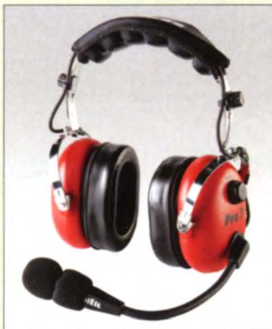
Das Pro7 hat ein abnehmbares Anschlusskabel und ist wahlweise mit dynamischer Mikrofonkapsel HC-7 oder mit Elektret-Kapsel für Icom-Transceiver lieferbar. Die Mikrofone sind auswechselbar, sodass ein Headset für beide Gerätefamilien verwendbar ist. Bei der Ausführung für Icom-Transceiver ist das Adapterkabel **AD1-IC** im Lieferumfang enthalten, bei den anderen Modellen ist wie üblich ein Adapterkabel **AD-1** erforderlich. Das Pro7 ist in verschiedenen Farben ab 269 € lieferbar.
