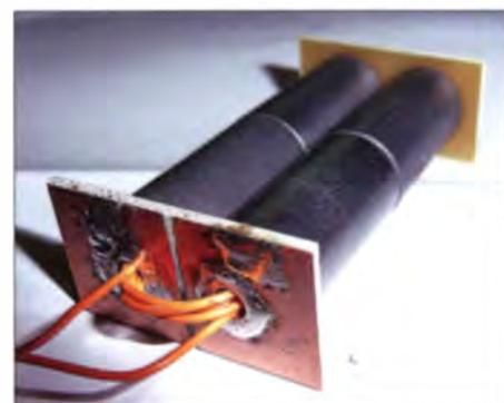
**Bild 7:** Praktische Ausführung des Transformators
