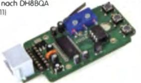
Speichert bis zu 60 Sekunden lange CO-Rufe. Ideal für Conteste, QRP- und Urlaubseinsatz. Austauschplatte für die Yaesu-Mikrofone MH-31 (FT-817/857/897, FT-950 usw.). Durch Jumper-Feld auch an Kenwood- und Icom-Transceivern nutzbar. Bausatz mit Platinen (SMD-Bauteile vorbestückt), PTT-Taster, Electret-Kapsel **BX-184 39,-**
