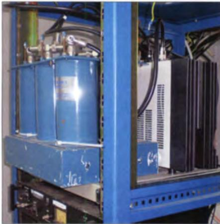
**Bild 9:** Links vorn drei Topfkreise eines Duplexfilters
