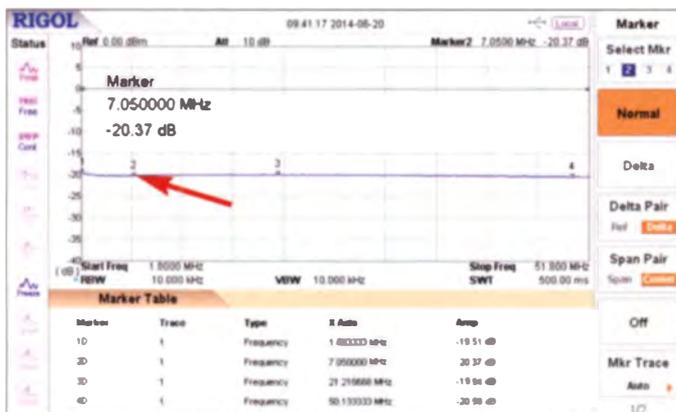
Zehntel dB (Bild 14). Das sind die Verluste im Ein- und Ausgangstransformator, die aber wirklich sehr gering ausfallen. Die gemessene Eingangsrückflussdämpfung (S-Parameter  $S_{11}$ ) sehen wir in Bild 15, die Ausgangsrückflussdämpfung (S-Para-
