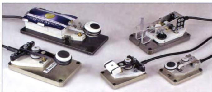
**Bild 1:** Gruppenfoto; l. o. DX4 (Jux-Taste mit Magnetkarte als Rückholfeder), l. u. Kurztaste DX6, r. o. DX2 in „Grundstellung“, r. u. Miniaturtaste DX8, Mitte DX7 mit rechteckigem Griff für zwei Finger
