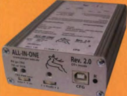
**Mobil Tracker 124/82/35 mm (L/B/H)** zum Übermitteln des Standorts in das APRS Netz. Integrierter 2m / 70cm TRX mit 5W und GPS Empfänger SIRF startV. Konfiguration über USB Port. Der ALL-IN-ONE R2 Tracker wird durch einen OpenTracker+ mit 2 Profilen und weiteren Features gesteuert. Profilwechsel durch Schalter. Trigger gesteuerte Aktivierung und zeitgesteuerter Nachlauf von 45 Min. mit anschließender kompletter Abschaltung des Trackers bis zum nächsten Trigger Impuls.
