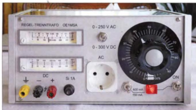
Bild 1: Frontansicht des Stelltrenntransformators
