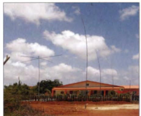
Der Bungalow mit den Antennen (v.l.n.r.): Spiderbeam, 160-/80-m-Vertikal, Triple Leg, und 40-m-Vertikal
