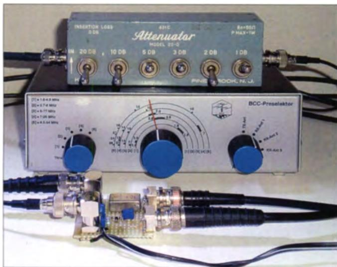
Bild 1: Dämpfungsglied und BCC-Preselektor sind Bestandteile des beschriebenen Versuchsaufbaus, mit dem das Prinzip der Frequenzteilung mit Mischstufen untersucht wurde. Im Vordergrund ist die auf einer Lochrasterplatte aufgebaute Testschaltung zu sehen.
