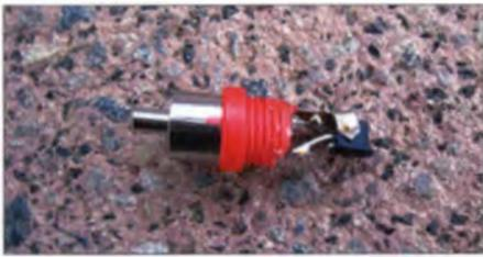
Bild 6: Der Schlüssel-IC im TO92-Gehäuse lässt sich bequem im Cinch-Stecker unterbringen und verdrahten.
