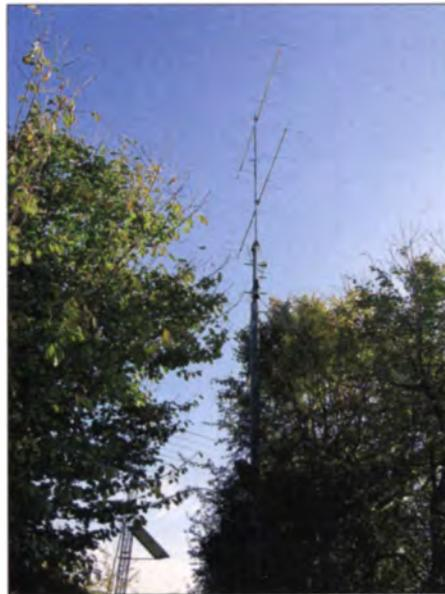
DK2GZ funkte mit zwei vertikal gestockten 8-Element-Yagis (8JXX); ordentlicher Gewinn bei relativ großem Öffnungswinkel – gut für Contestbetrieb.
