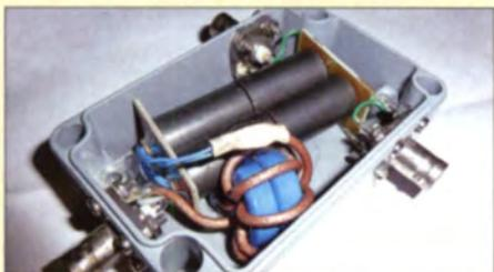
In diesem Beitrag werden Eigenschaften und Anwendung von im Leerlauf- oder im Kurzschlussbetrieb arbeitenden sowie von abgeschirmten Loops für Empfangszwecke erörtert. Als entscheidend für die Funktion erweisen sich ein korrekt aufgebaute Transformator inklusive Balun und ein geeigneter Verstärker.
