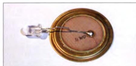
Bild 2: Bei der Verbindung einer LED mit einem Piezoelement lässt sich der Piezoeffekt leicht nachweisen.
