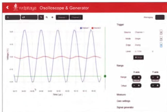
**Bild 4:** Ein- und Ausgangssignale des 10,7-MHz-Filters bei 10,5 MHz, aus denen sich die Dämpfung errechnen und die Phasenverschiebung ablesen lassen.
